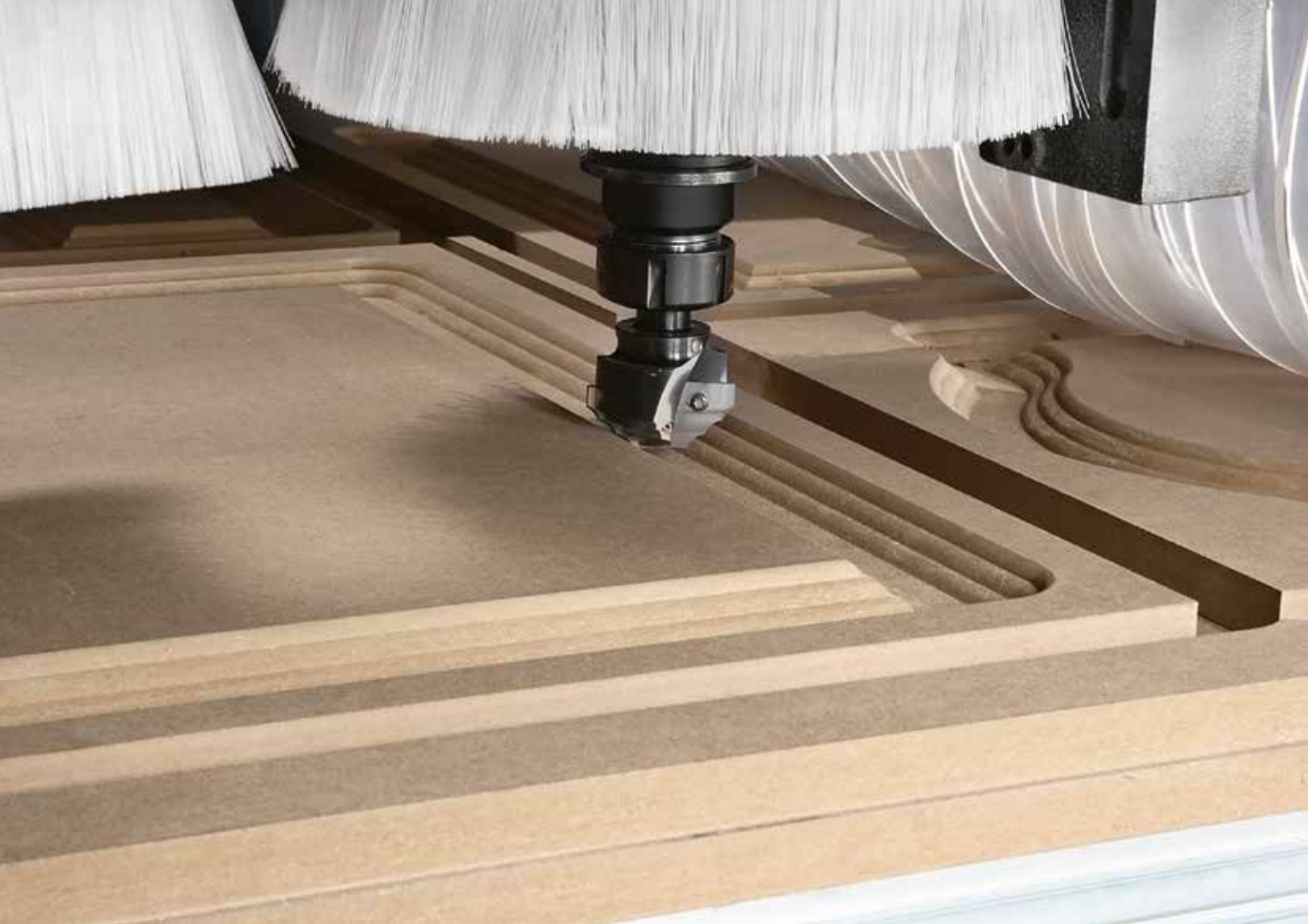
ptimale Bearbeitungspräzision mit der 3-achsigen Elektrospindel bis zu 24.000 U/min.
