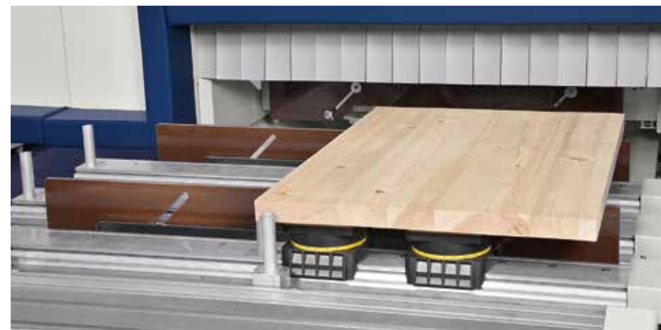
Einfache Positionierung von schweren Werkstücken und großdimensionierten Platten durch die Positionierhilfen.
