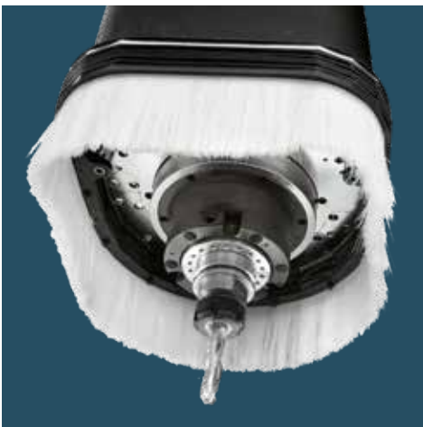
Höhere Produktivität und Verkürzung der Fertigungszeiten mit der zusätzlichen Fräsgruppe mit 4,5 kW Motorleistung.
