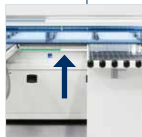
LED-Leiste zur Positionierung der Tischen. Assistierte Verwaltung der Positionierung des mobilen Luftkissentisches entsprechend dem Plattenformat.
